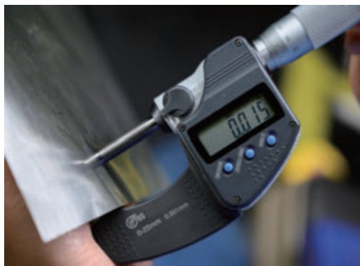
图8-7 我国生产的超薄不锈钢精密箔材
