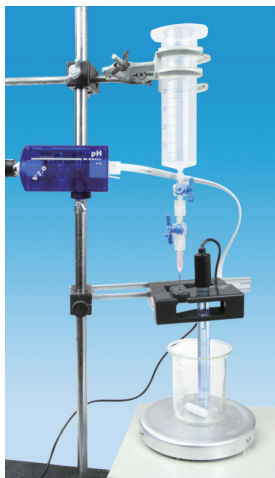
图 7-15 用 pH 传感器测定酸碱反应的 pH 变化
