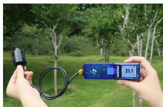
图 4-2 利用传感器测量空气中氧气的含量
