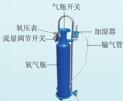
图 4-18 某供氧器的构成示意图
