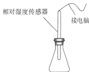
图1 相对湿度传感器通过橡皮塞与锥形瓶连接
