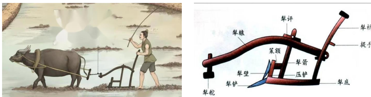
图 4-3 耕地 曲辕犁的构造
