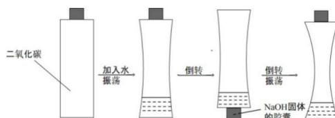
实验改进后，只需用一个溶于水胶囊与一个塑料瓶完成实验，装置简单，对比明显；将原本无明显现象的反应可视化，便于学生从两个角度验证反应的发生，即反应物消失和新物质生成的角度。通过对实验的观察，借助直观的现象，获得丰富的感性认识，以此为基础，证明反应的发生，让化学实验成为学生“证据推理”意识。本实验的装置易得，操作简单，现象明显。一体化设计，整体性强。同一装置，先后的对比，胶囊溶解前后的现象差异，说明了二氧化碳与氢氧化钠发生了化学反应。
