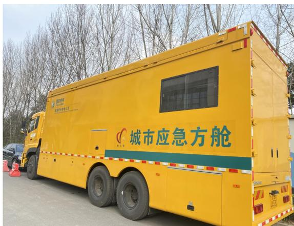
“应急充电方舱”车辆像一个“大型充电宝”，移动式“应急充电方舱”的投用，将有效解决高速充电设施平时利用率不高与节假日充电爆发式增长之间的矛盾，保障电动汽车“行稳致远”。
