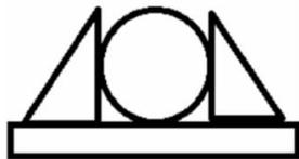
图1:直尺和三角尺测量罐子直径方法
