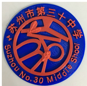
图 9 采用换线法打印出的 3D 模型
