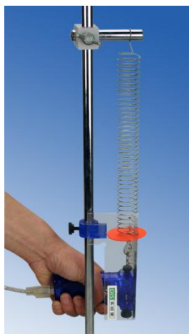
图 3 探究弹簧弹力与形变量之间的关系实验装置 表 7 探究弹簧弹力与形变量之间的关系实验结果
