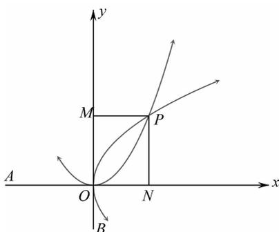
图2 利用两条抛物线交点来解倍立方问题
