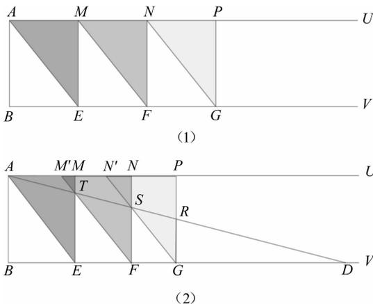
图 5 埃拉托色尼的倍立方机械解法
